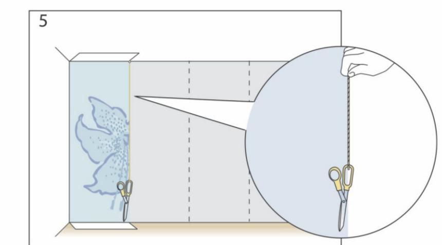
5. Прежде чем разглаживать обои на стене, убедитесь с помощью отвеса, что верхняя и нижняя части первой полосы обоев легли вертикально. Никогда не пытайтесь сдвинуть уже приклеенную полосу обоев в каком-либо направлении. Если вы совершили ошибку, снимите полосу и начните всё сначала. Используйте при необходимости дополнительное количество клея для флизелиновых обоев.
