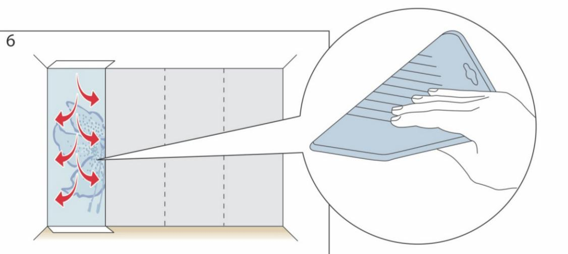
6. Используйте обойный инструмент для разглаживания обоев, а также снятия лишнего клея для флизелиновых обоев и пузырей. Держите инструмент в чистоте! Постоянно очищайте инструмент от клея для флизелиновых обоев. Разглаживайте обои с помощью обойного инструмента от потолка к полу и от центра к краям.
