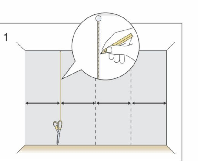
1. Установите по отвесу начальную линию. Для достижения наилучшего результата нанесите карандашом направляющие линии прямо на стену. Внимание, яркие следы от карандаша и полностью проведенные на стене линии могут просвечивать с внешней стороны обойного полотна.
