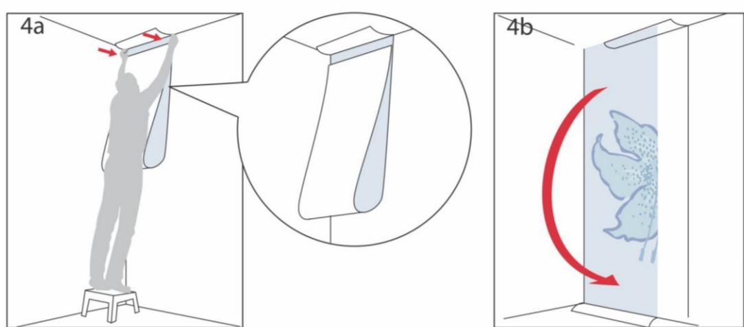
4. Прежде чем поднести полосу к стене, сложите её пополам рисунком вовнутрь, чтобы избежать попадания клея на лицевую сторону обоев. Закрепите затем верхнюю часть на правильной высоте и в правильном положении, прежде чем начнёте разворачивать всю полосу вниз.
