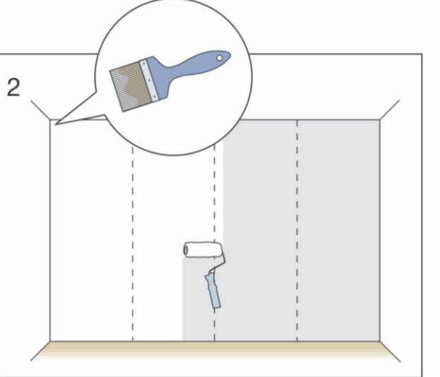
2. Нанесите клей для флизелиновых обоев на стену приблизительно на ширину 2-3 полос. Важно распределить клей для флизелиновых обоев равномерно по всей поверхности. Из-за не промазанного клеем участка на обоях может появиться пузырь. Используйте кисть в тех местах, где сложно нанести клей для флизелиновых обоев с помощью валика.
