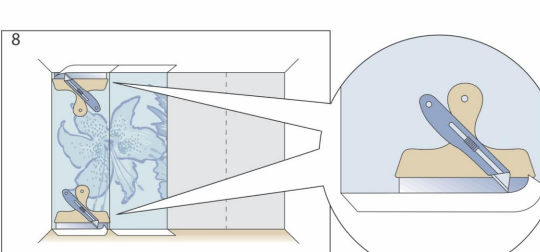
8. Отрежьте лишнее (инструкции, белые поверхности). Используйте в качестве подстопья для чистовой обрезки стальную линейку или широкий шпатель. Чаше менять лезвие обойного ножа. Тупое лезвие легко может повредить полотно.
