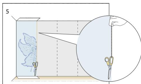
5. Прежде чем разглаживать обои на стене, убедитесь с помощью отвеса, что верхняя и нижняя части первой полосы обоев легли вертикально. Никогда не пытайтесь сдвинуть уже приклеенную полосу обоев в каком-либо направлении. Если вы совершили ошибку, снимите полосу и начните всё сначала. Используйте при необходимости дополнительное количество клея для флизелиновых обоев.
