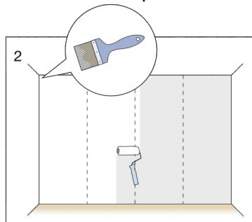
2. Нанесите клей для флизелиновых обоев на стену приблизительно на ширину 2-3 полос. Важно распределить клей для флизелиновых обоев равномерно по всей поверхности. Из-за не промазанного клеем участка на обоях может появиться пузырь. Используйте кисть в тех местах, где сложно нанести клей для флизелиновых обоев с помощью валика.
