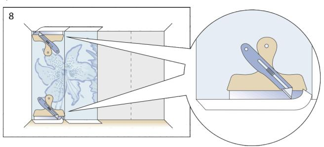
8. Отрежьте лишнее (инструкции, белые поверхности). Используйте в качестве подспорья для чистовой обрезки стальную линейку или широкий шпатель. Чаше менять лезвие обойного ножа. Тупое лезвие легко может повредить полотно.
