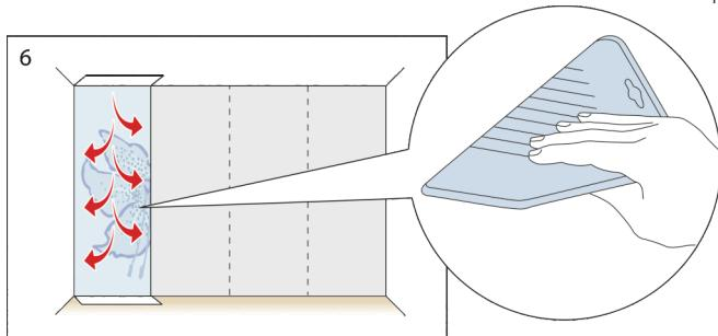
6. Используйте обойный инструмент для разглаживания обоев, а также снятия лишнего клея для флизелиновых обоев и пузырей. Держите инструмент в чистоте! Постоянно очищайте инструмент от клея для флизелиновых обоев. Разглаживайте обои с помощью обойного инструмента от потолка к полу и от центра к краям.
