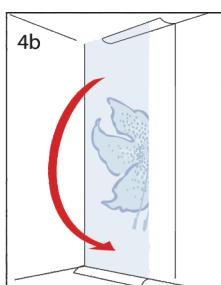
4. Прежде чем поднести полосу к стене, сложите её пополам рисунком вовнутрь, чтобы избежать попадания клея на лицевую сторону обоев. Закрепите затем верхнюю часть на правильной высоте и в правильном положении, прежде чем начнёте разворачивать всю полосу вниз.
